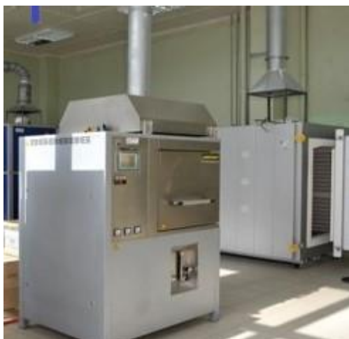
Рисунок 28 - Высокотемпературная электрическая печь
